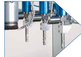
Effizienz und Flexibilität durch 3-fach-Wasserstrahl-schneidkopf mit integriertem Fräskopf
