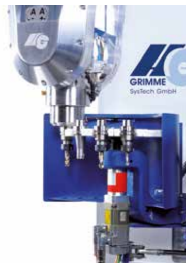
Werkzeugwechsel-Magazin für 10/20 Werkzeuge, Werkzeuglänge bis 260 mm
