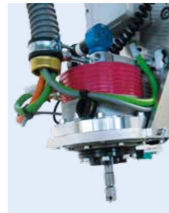
Schneidkopf oszillierend für Schnitte in echtem Leder
