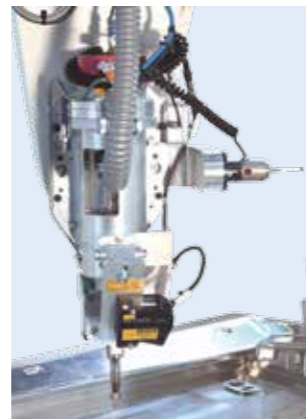
Schneidkopf Ultraschall für Schnitte in TPO, TPU, PVC, PUR
